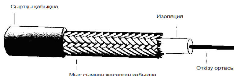
2-сурет. Коаксальды кабельдің құрылымы
